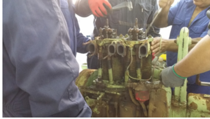
Figura 1. Desmontaje motor de Bote de Rescate.
