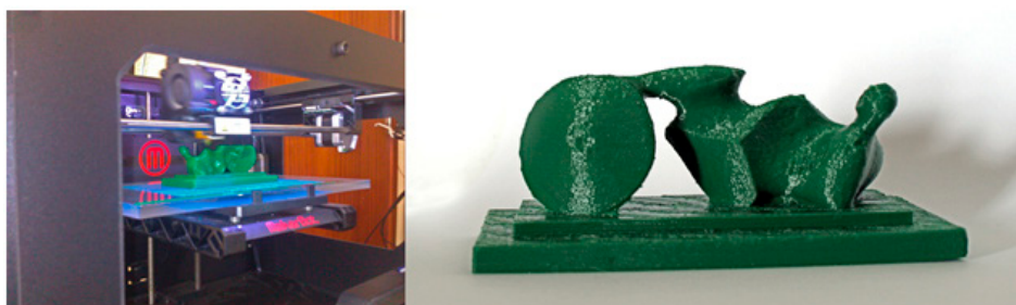
Figura 7. Impresora MakerBot Replicator 2 imprimiendo réplica del Guerrero de Goslar en PLA. (Imagen de autoría propia).
