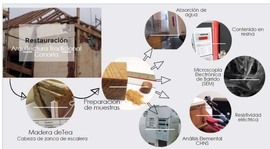
Figura 1. Esquema de ensayos y técnicas usadas para la caracterización.
