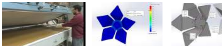
Imagen de la maquinaria utilizada para este proceso. Por su parte, el departamento técnico de KrionTM colaboró realizando cálculos de resistencia de los anclajes por ordenador. Imágenes de los resultados de los cálculos.
