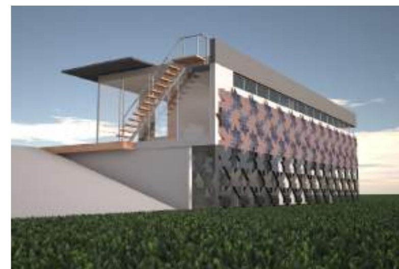
Figura 4 – Proposta de fachada arquitetônica com módulos em cobre e módulos fotovoltaicos, alternados na parte superior.
