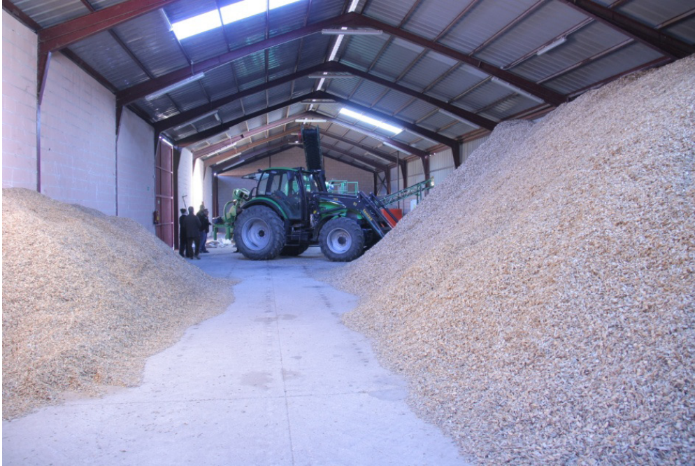
Figura 12.1; Interior de la nave, pilas de astillas clasificadas según su tamaño, G30 - G50, al fondo tractor, detrás máquina de cribado. (Ignacio López (CTFC))
