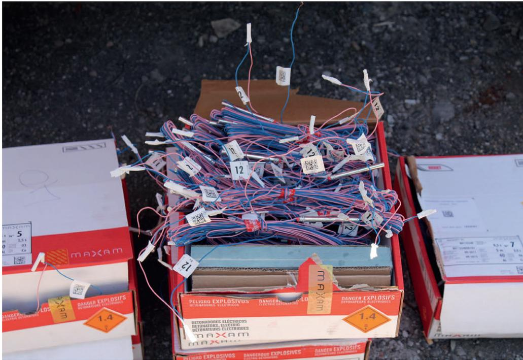
Figura 6.1.- Detonadores para uso en galerías de agua.
