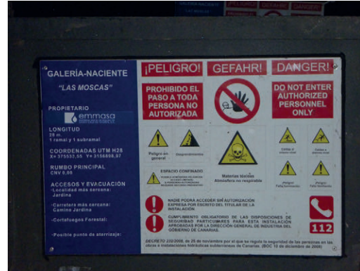
Figura 7.11.- Cartel obligatorio de información sobre la galería y peligros.
