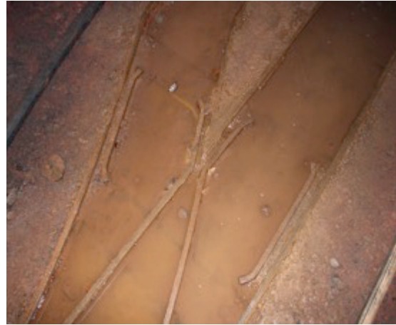
Figura A.11.- Rails en proceso de oxidación al estar "embebidos" en el agua de repisa de la mina.
