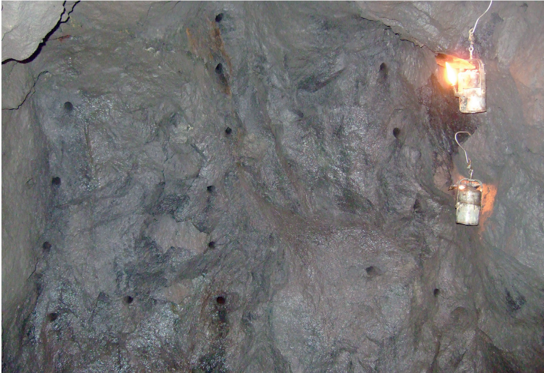
Figura A.12.- Perforación de barrenas para la introducción de explosivos. (Foto cortesía de Rafael Lario).
