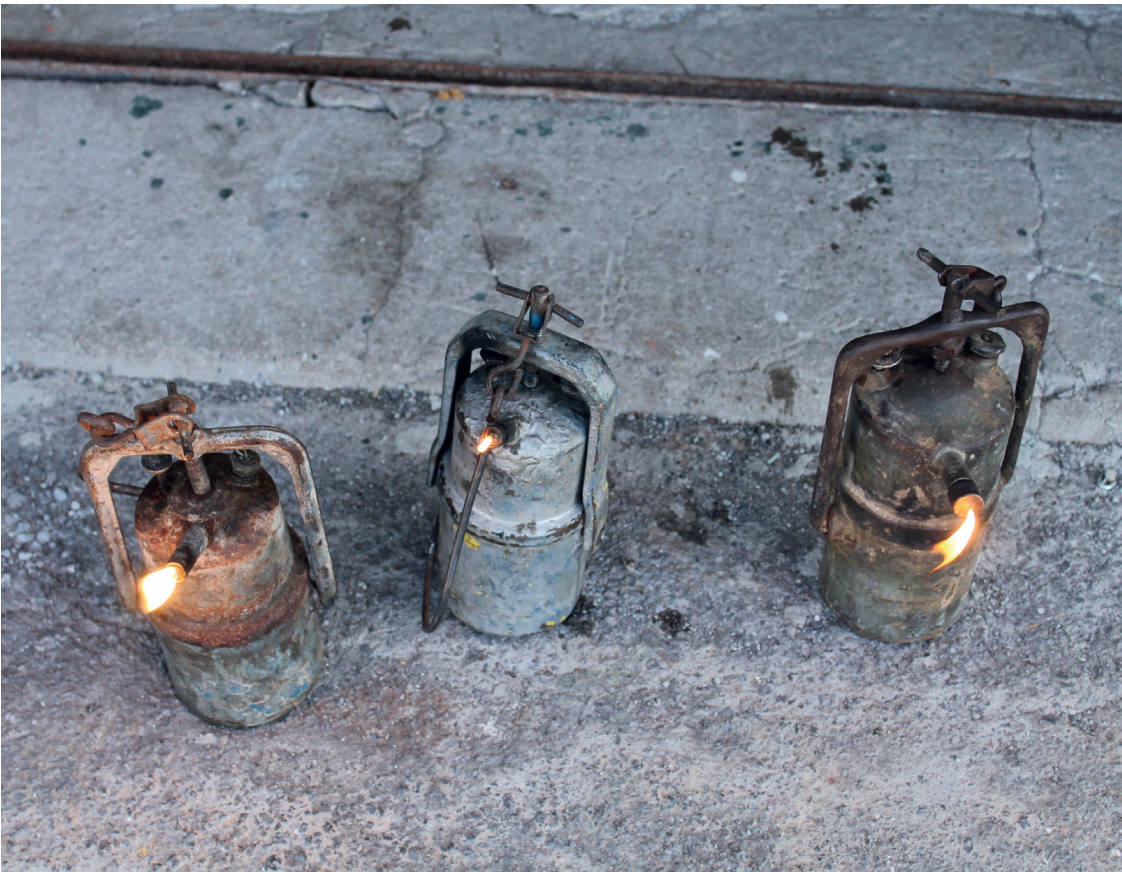
Figura A.8.- Lámparas de carburo de acetileno, ampliamente utilizadas en la actualidad en la minería del agua.
